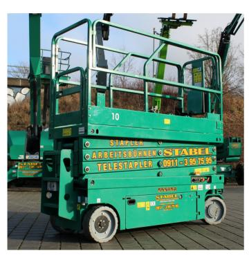
Arbeitshöhe bis max. 10,00 m Plattformhöhe bis max. 8,00 m **Traglast** 230 kg Plattformgrösse 2,19 / 0,74 m Erweiterbar auf 3,10 / 0,74 m **Antrieb** Elektro Länge / Breite / Höhe 2,59 / 0,83 / 2,36 m Eigengewicht 2250 kg Transportmöglichkeit auf LKW oder Tieflader
